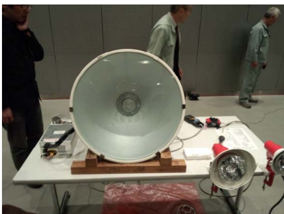
マイクロ波電灯、中央の電球、 \phi=3\text{cm}
